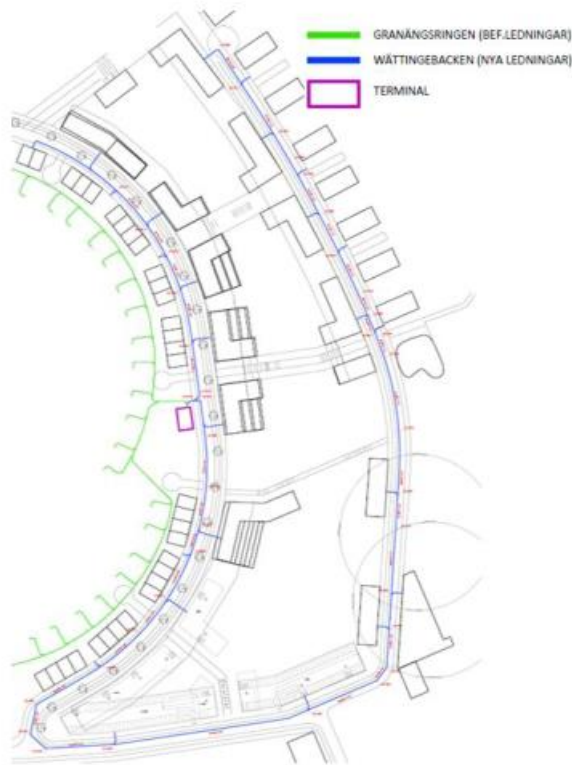
Figur 4. Rörlayout för sopsug i Wättingebacken.
