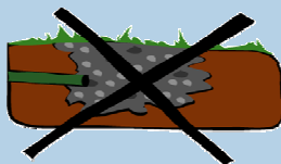
...stor risk för igensättning och lokal dämning..
